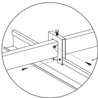
DHクリップのビス留め箇所は補助チャンネル側、DHクロス側にそれぞれ1ヶ所合計2ヶ所ビス (φ4×19) 留めする。
