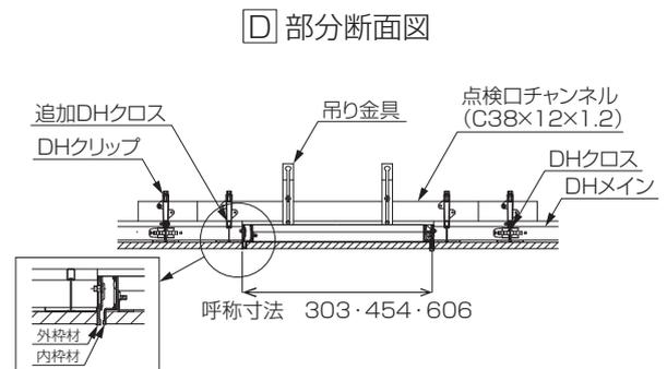
●推奨：下地開口補強工事不要な点検口の納め (300×600タイプなど)
